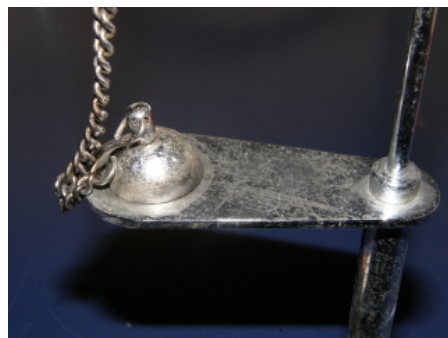
(b) La sfera, calda, è troppo grande per poter passare nel foro
