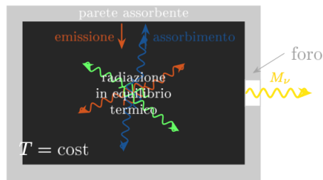
Figure 1: Cavit  di corpo nero. Le pareti assorbono ed emettono continuamente radiazione in equilibrio termico alla temperatura T . La luce che fuoriesce dal foro   caratterizzata dall'emittanza spettrale M_\nu , che dipende solo da T , non dal materiale delle pareti.
