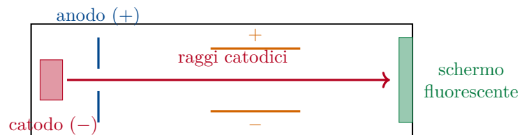
Figura 21.1: Schema di un tubo a raggi catodici. Gli elettroni emessi dal catodo vengono accelerati verso l'anodo (forato), proseguono in linea retta nello spazio fra le placche di un campo elettrico trasversale e raggiungono lo schermo fluorescente. Misurando la deflessione in funzione dei campi applicati, Thomson determinò il rapporto e/m_e .
